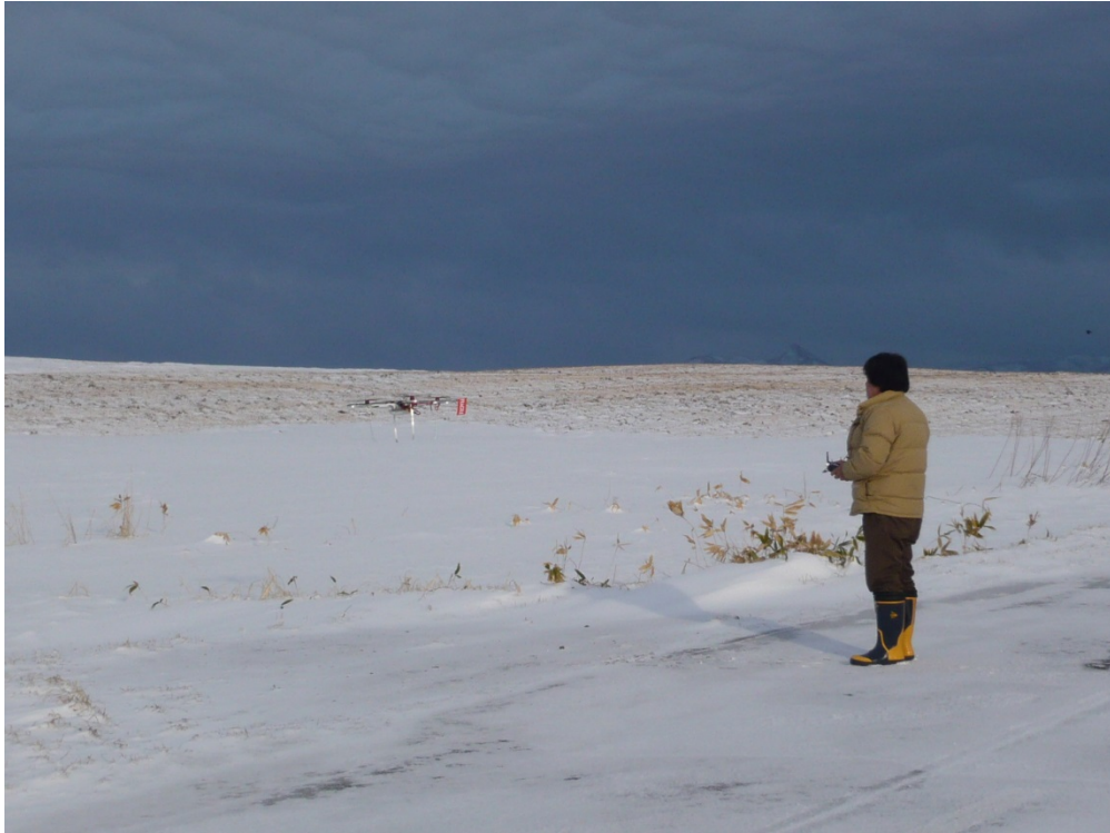
図 17 吹きだまり計測（小型 UAV による写真撮影）の様子（2014 年 4 月 21 日）。 写真は UAV の離陸直後の様子。
