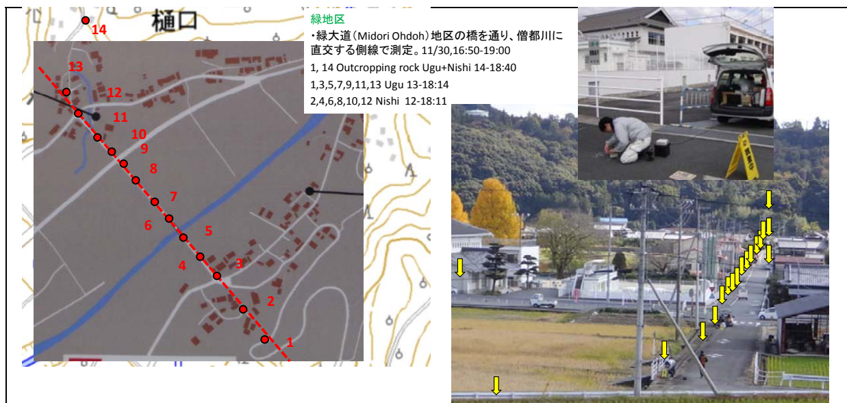
図-13 緑地区 3 測線の内の MOD 微動測線分布と微動観測の様子
