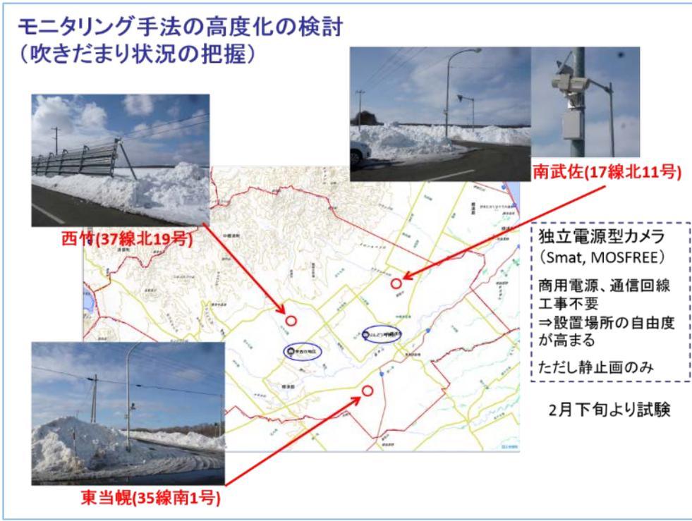
図 14 独立電源型カメラを用いた吹雪、吹きだまりモニタリングシステム。
