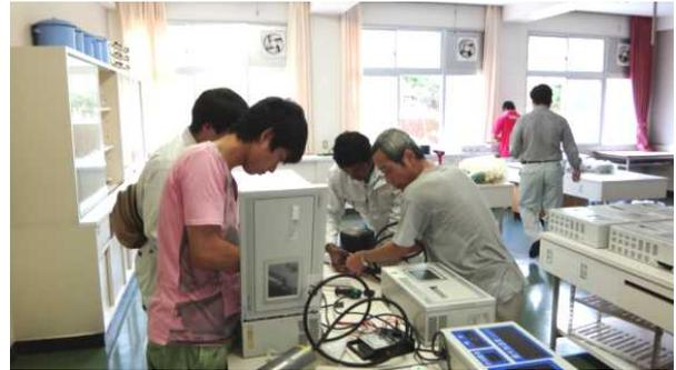
図-29 自治体廃棄震度計の動作確認点検の様子(2014年8月19日、元・西海中学校)
