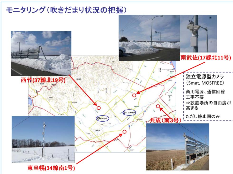
図 13 独立電源型カメラを用いた吹雪、吹きだまりモニタリングシステム。2016年1月以降、4台のカメラを設置した（前年度は3台のみ）。
