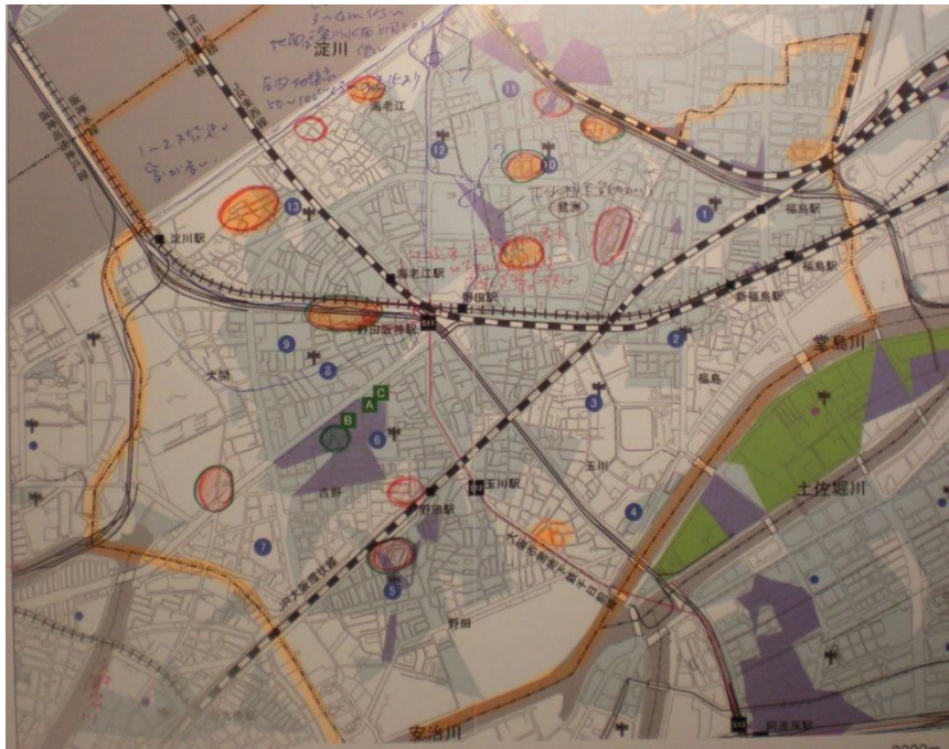
図-2 福島区役所管内の内水はん濫防災マップとはん濫実績 緑色：H20.7.28、赤色H24.8.18、オレンジ色：H25.8.25
