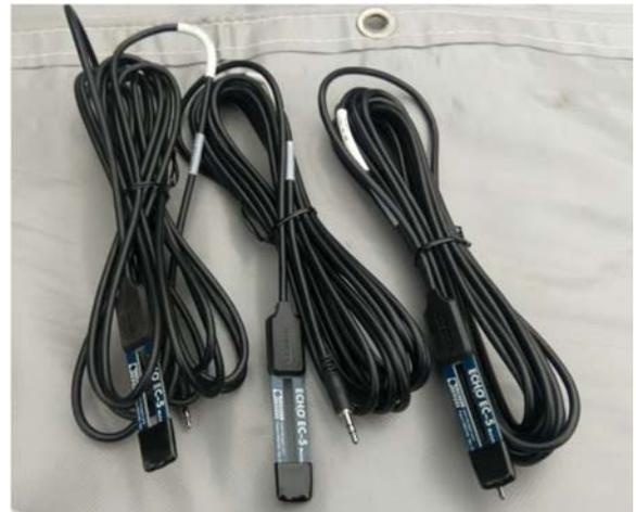
写真 2-2 飽和度計測用誘電率センサ
