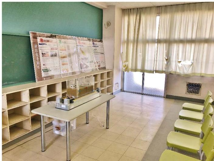
写真 3-2 千葉大学サテライトキャンパスに設置した簡易液状化実験装置と説明パネル
